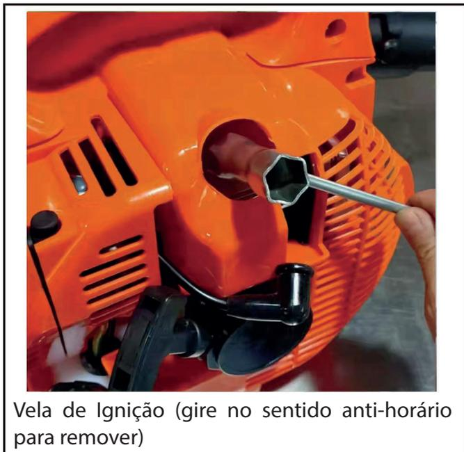
1. Use a chave de vela para remover a vela de ignição (gire no sentido anti-horário para remover).
