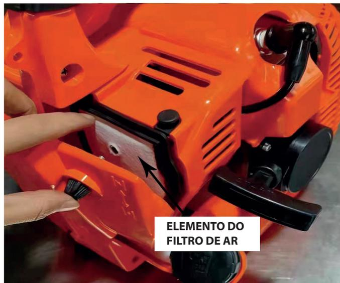
1. Afrouxe o parafuso de retenção da tampa do filtro de ar e remova a tampa e o elemento do filtro.
