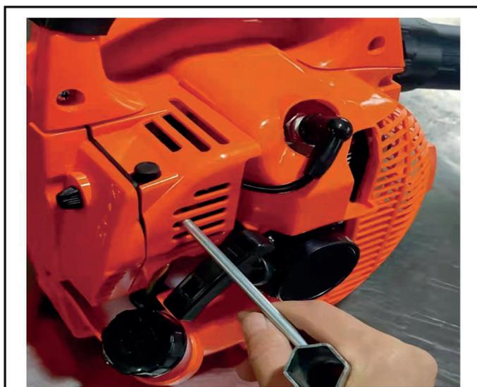
Parafuso de Ajuste de Velocidade de Marcha Lenta (acessível através da grade do capô).
