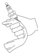
9.2.4 Verifique o eletrodo da vela e ajuste se necessário. O ajuste correto é 0,7 ~ 0,8mm.
