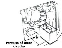
10.4 Com uma chave específica solte o bujão do óleo e drene totalmente.
